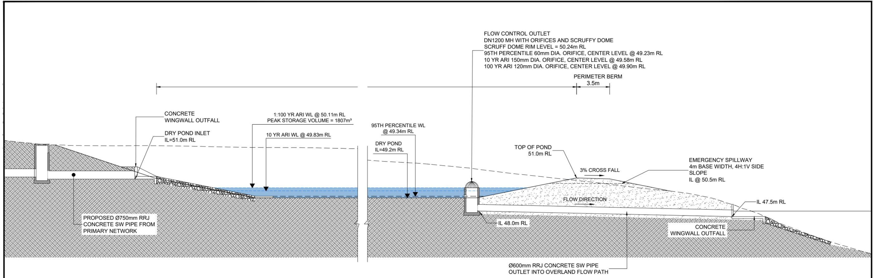
**A | TYPICAL DRY POND CROSS SECTION**
