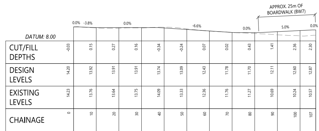
2 TP8 LONGSECTION SCALE: 1:1000 @ A3
