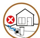
確保物業上的地表徑流路徑不受物品、建築和垃圾堵塞，以保持水流暢通。
