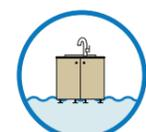
櫥櫃改用抗洪材料並選用可拆卸踢腳板，以便在洪水過後更容易對其進行清洗和晾乾。
