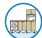
將洗衣機和乾衣機等洗衣設備安裝在檯面或壁掛支架上，升高焗爐和微波爐等廚房電器位置，以降低受到洪水損壞的風險。
