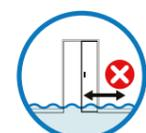
改用雙開式彈簧門或平貼式推拉門取代入牆式推拉門，儘量減少水流灌入牆體內。
